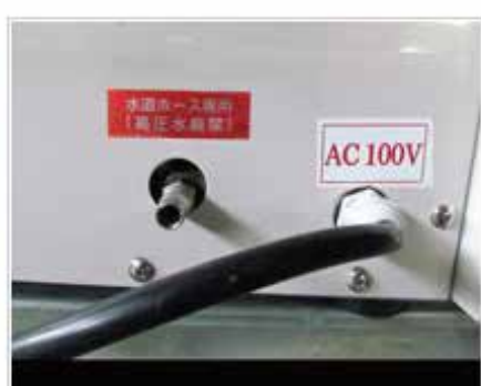
電源・給水口
